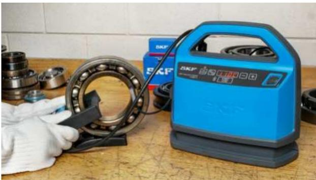
Herzstück des TMBH 5 ist eine Induktionsklemme mit internen Spulen. Stromfluss in den Spulen erzeugt ein fluktuierendes Magnetfeld. Dieses induziert einen Stromfluss in den Komponenten, der in Hitze umgewandelt wird. Da sich die Komponenten (und nicht die Klemme) selbst erwärmen, wird ein hoher Wirkungsgrad erreicht.
