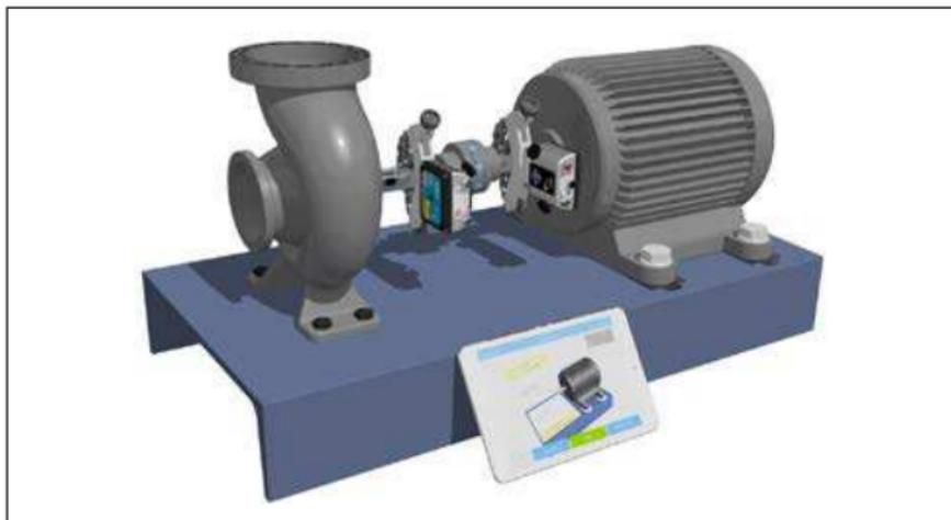
Montieren Sie das Messgerät M an die bewegliche Maschine. Montieren Sie das Messgerät S an die stationäre Maschine.
