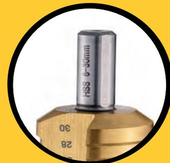
Dieser Stufenbohrer mit zwei tiefengeschliffenen geraden Spannuten gewährleistet ein ratterfreies Arbeiten bis 4 mm Materialstärke. Durch seinen Kreuzanschliff ist dieser Stufenbohrer selbstzentrierend und benötigt nur eine geringe Vorschubkraft. Der 3-Flächenschaft sorgt für eine optimale Kraftübertragung bei handgeführtem Einsatz.
