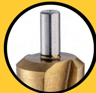
Dieser Blechschälbohrer mit zwei tiefengeschliffenen geraden Spannuten bietet eine absolute Laufruhe und eine hohe Schnittleistung. Durch seinen Kreuzanschliff ist dieser Blechschälbohrer selbstzentrierend und benötigt nur eine geringe Vorschubkraft.
