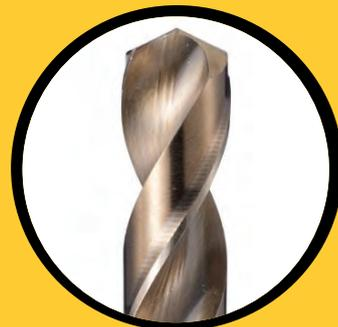
Dieser kräftige bronzierte Hochleistungsspiralbohrer mit ausgeprägter Warmhärtefestigkeit überzeugt durch sein unvergleichbares Preis-Leistungsverhältnis. Durch seinen Kreuzanschliff ist dieser Spiralbohrer selbstzentrierend. Er hat ein ruhiges Bohrverhalten, ist sehr stabil, und besitzt eine hohe Bruchsicherheit. Durch diese robuste und langlebige Ausführung ist er ein idealer Spiralbohrer für den Baustellen- und Montageeinsatz.
