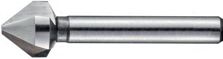
Dieser 90° Kegel-und Entgratsenker mit V-Nut erzielt beste Ergebnisse beim Ansenken und Entgraten von Bohrungen bei niedrigen Schnittgeschwindigkeiten. Durch seinen gleichmässig verlaufenden Kegelmantel-Anschliff ergibt sich ein guter Schnitt und verhindert dabei ein Verklemmen der Späne im Werkstück. Der 3-Flächenschaft sorgt für eine optimale Kraftübertragung bei handgeführten Einsatz.
