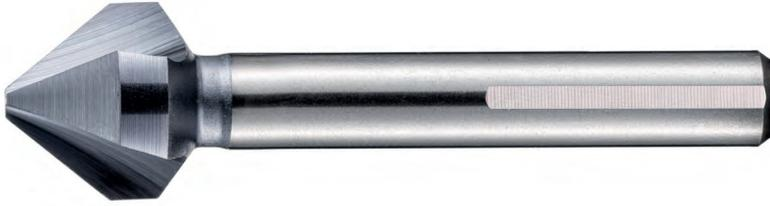
Der Alleskönner unter den professionellen Kegel und Entgratsenkern mit einer ungleichen Teilung der drei Hauptschneiden und einem 3-Flächenschaft für perfekt kreisrunde Senkungen. Die Multilayer-Superhartstoffbeschichtung Titan-Aluminium-Nitrid kurz TiAlN sorgt für eine lange Standzeit und höchste Performance. Dieser Hochleistungskegelsenker wurde speziell für den Einsatz in Akku-Bohrmaschinen entwickelt.
