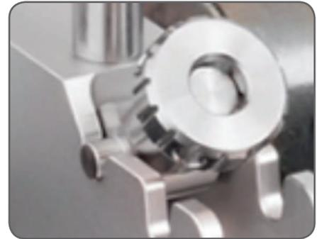
Dabei ist sicherzustellen, dass die Stangen **fest** an den Winkeln anliegen, bevor die Messeinheiten montiert werden.
