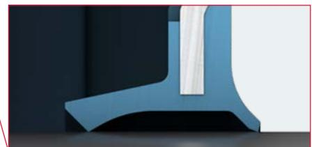
**Dynamisch:** Zweilippendichtung mit aus- reichender Überdeckung. Maximal 1° Schiefstellung zulässig.
