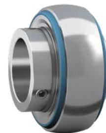
Das Lager ist als einreihiges Rillenkugellager mit kugeliger Außenringmantelfläche ausgeführt. Die kugelige Fläche passt zu einer entsprechend kugelig, aber konkav ausgeführten Gehäusebohrung. Die Spannlagereinheiten ermöglichen den Ausgleich von fertigungs- oder montagebedingten Fluchtungsfehlern.
