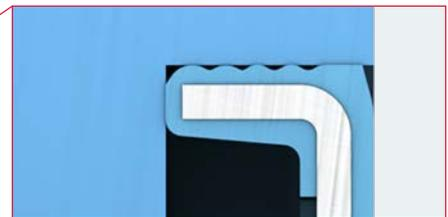
**Statisch:** Der rillierte Elastomeraußenman- tel dichtet statisch zum Gehäuse hin ab.
