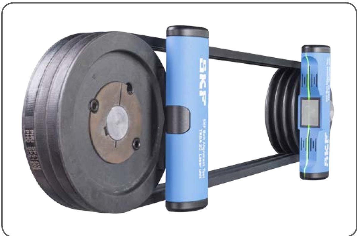
Abbildung 4 An den Riemenscheiben befestigte Einheiten
