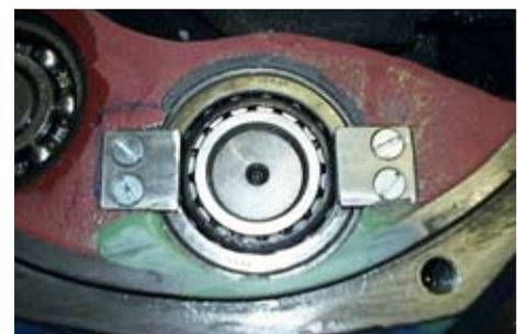
Instandsetzung eines Getriebegehäuses
