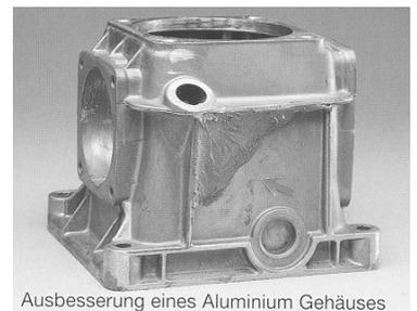
Ausbesserung eines Aluminium Gehäuses
