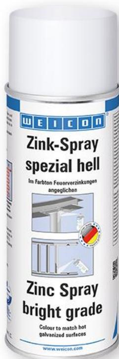
WEICON Zink-Sprays bieten schnelltrocknenden Korrosionsschutz mit Langzeitwirkung für alle Metalle. WEICON Zink-Spray DIN 50976 (Farbton Zink grau) enthält im Trockenfilm einen Anteil von 92 – 93% reinem Zink und 7 – 8% Kunstharz. WEICON Zink-Spray „spezial hell“ ist im Farbton Feuerverzinkungen angeglichen.
