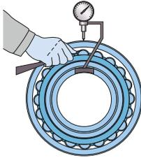
10. Eine weitere Fehlerquelle bei Messungen ist die elastische Verformung der Ringe durch das Gewicht des Lagers.
