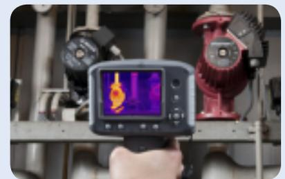
Wärmebildkameras erlauben die schnelle Lokalisierung von Hotspots
