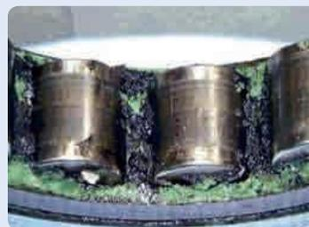
Verschmutzter Schmierstoff durch Funkenerosion
