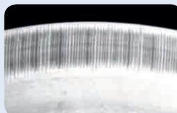
Typische Riffelung bei Funkenerosion in Wälzlagern
