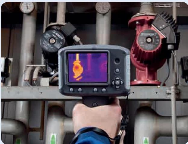
Wärmebildkameras erlauben die schnelle Lokalisierung von Hotspots
