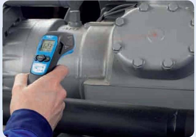
Im kontaktlosen Modus misst das SKF Infrarot-Thermometer die Temperatur eines Objekts. Direkt auf ein Objekt gerichtet, sammelt das SKF Infrarot-Thermometer Temperaturdaten und erzeugt ein Signal, das der Mikroprozessor verarbeitet und auf dem hintergrundbeleuchteten Display anzeigt. Ist der Auslöser gedrückt, wird die Temperatur des Objekts fortlaufend durch das SKF Infrarot-Thermometer gemessen. Dies ermöglicht schnelle und genaue Messwerte in Echtzeit
