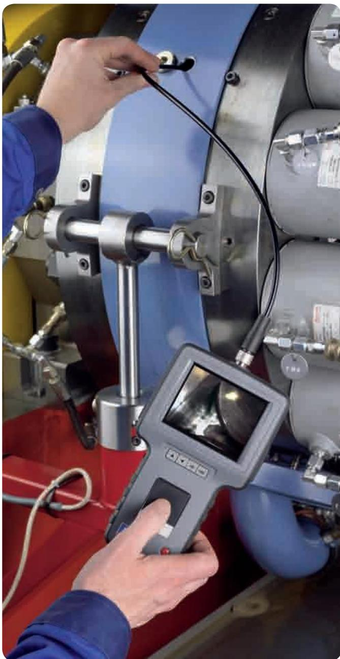
Die flexible Sonde ist mit einer Miniatur-Kamera ausgerüstet, die über eine starke variable LED-Lichtquelle verfügt. Das TKES 1 kann als einfaches Kontrollinstrument zur Inspektion verwendet werden, mit dem sich sowohl Zeit als auch Geld sparen lässt, da die zu kontrollierenden Teile für die Inspektion nicht mehr auseinandergebaut werden müssen.
