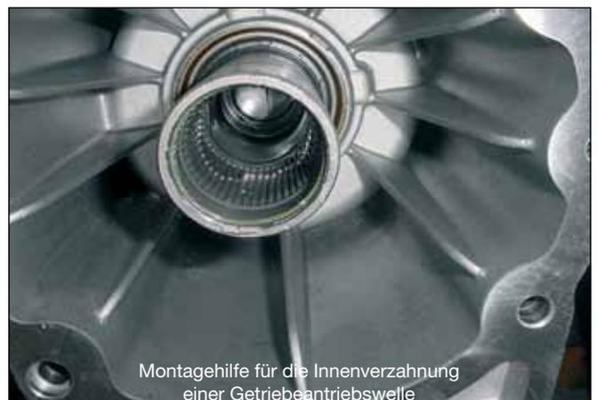
Montagehilfe für die Innenverzahnung einer Getriebeantriebswelle
