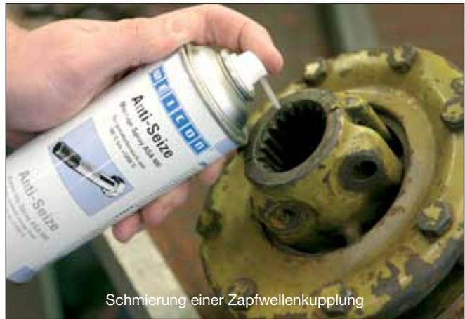
Schmierung einer Zapfwellenkupplung
