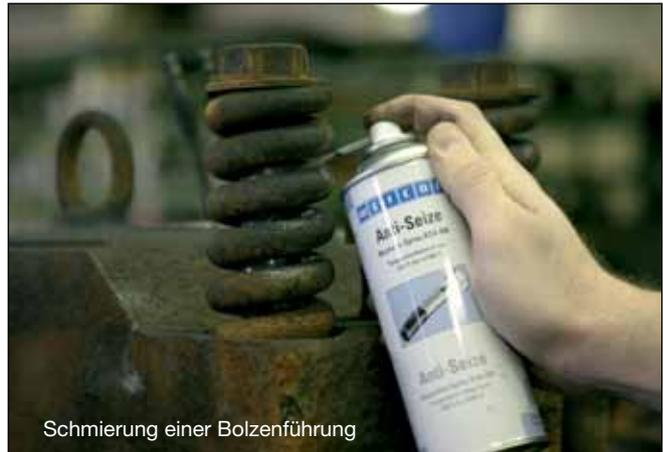
Schmierung einer Bolzenführung
