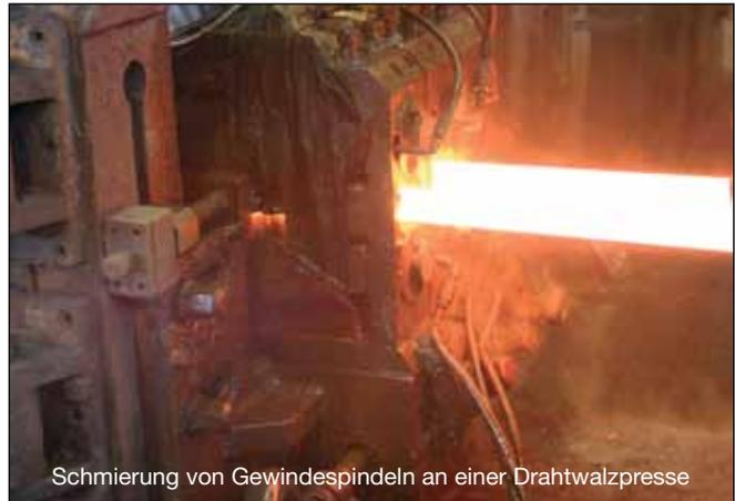
Schmierung von Gewindespindeln an einer Drahtwalzpresse
