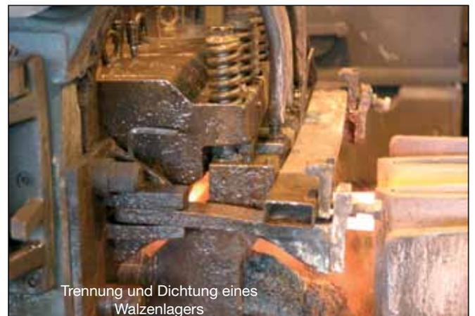
Trennung und Dichtung eines Walzenlagers
