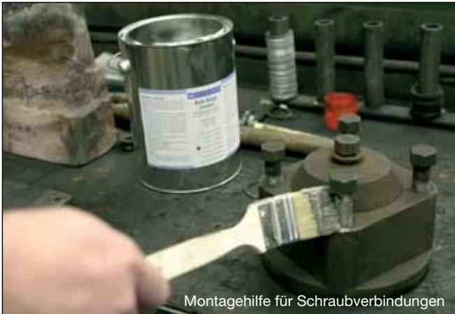
Montagehilfe für Schraubverbindungen
