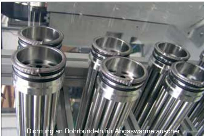
Dichtung an Rohrbündeln für Abgaswärmetauscher
