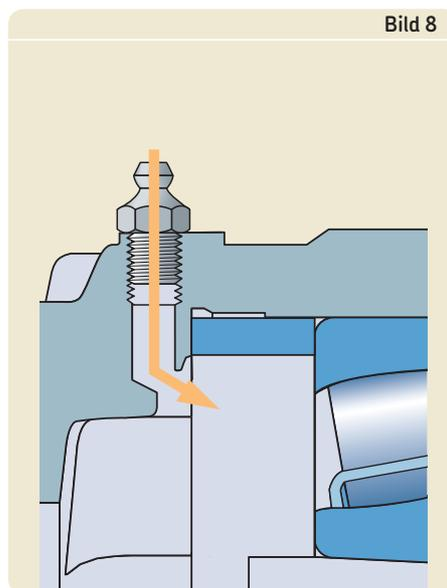
Gehäuse für Ölschmierung
