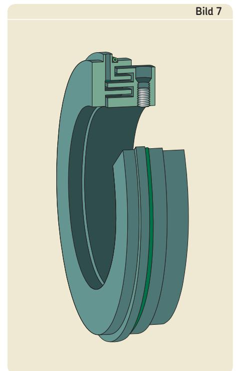
der Dichtung erfolgt über Schmiernippel und Schmierbohrung im Gehäuseoberteil. Die Lage der Bohrung für den Schmiernippel ist durch eingegossene Ankörnungen markiert. Der umlaufende Labyrinthring ist mit einem Gewindestift auf der Welle festgesetzt.
