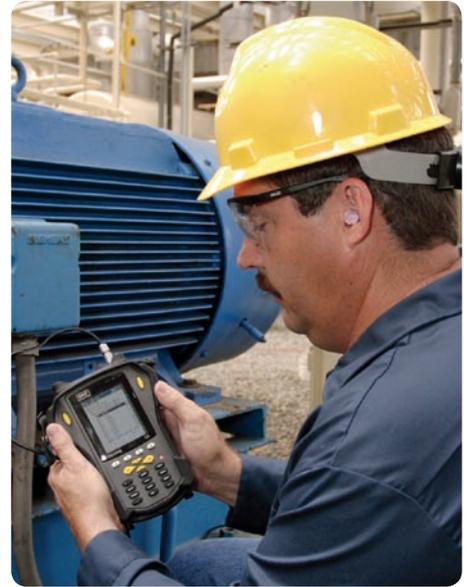
*Schwingungsmessung mit Hilfe des SKF Microlog Datensammlers/-analysators*
