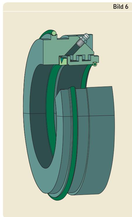
schnur aus Silikon-Kautschuk (VMQ) sorgt dafür, dass sich der mit loser Passung eingebaute Labyrinthring mit der Welle dreht.
