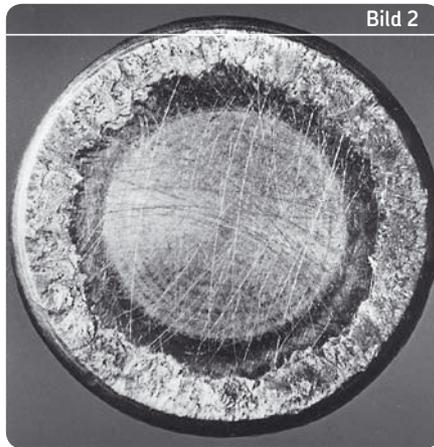
Anschmierungen an einem Führungsbord, verursacht durch hohe Axialbelastung und unzureichende Schmierung.
