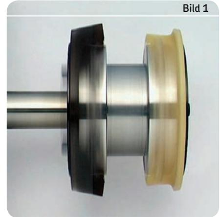
Vergleich eines Standard Polyamidkäfigs mit einem E2 Polyamidkäfig bei einer Drehzahl von 8 000 min<sup>-1</sup>. Der E2 Käfig auf der rechten Seite weist eine wesentlich geringere Verformung auf.
