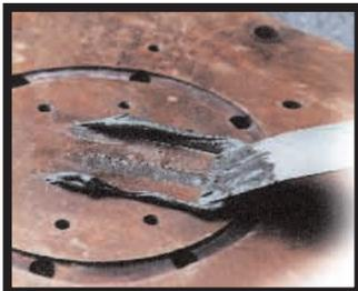
**Loctite® Hysol® 3473 A&B** ein schnell aushärtender, stahlgefüllter 2K-Epoxid-Klebstoff für Notfall-Reparaturen und die Nachbildung verschlissener Metallteile. Ideal um Ausfallzeiten zu verringern.
