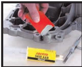
**Loctite® Hysol® 3450 A&B** ist ein Fünf-Minuten 2K Epoxid-Klebstoff, der sich für Spaltreparaturen und -füllungen eignet. Ideal zum Kleben und Füllen beschädigter Bauteile.
